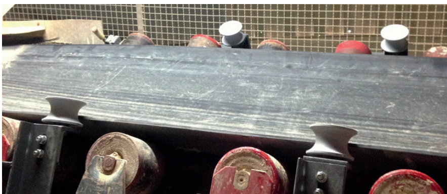
Utilisation de galets de guidage de bande réglables en hauteur
