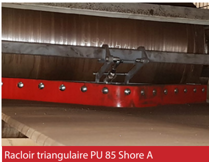
Racloir triangulaire PU 85 Shore A
