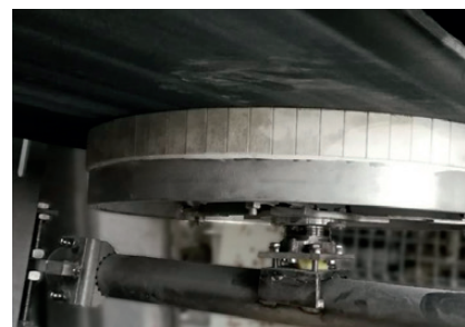
ROTA avec élément racleur en céramique
