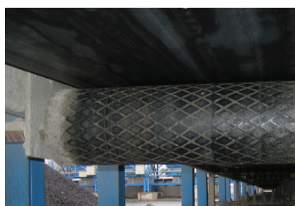
Rouleau correcteur avec revêtement caoutchouc en losanges
