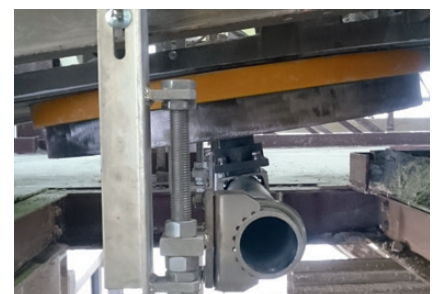
ROTA mit Polyurethan Abstreifelement
