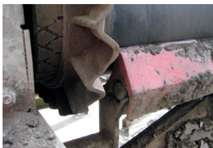
Verkröpfter Grundkörper an Wellenkantengurt
