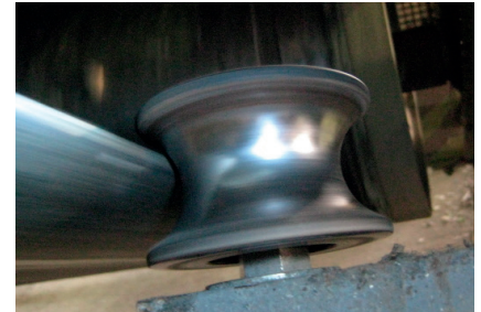
Konkav geformter Rollenkörper
